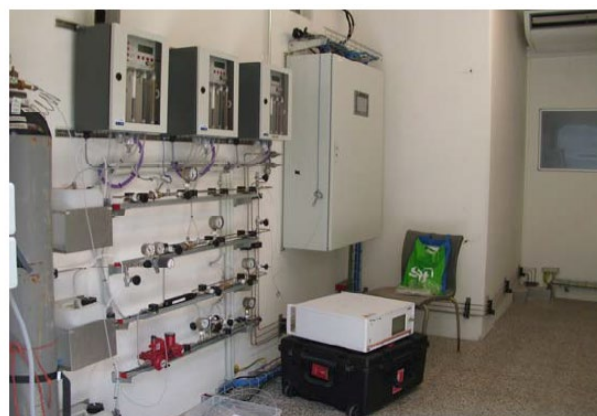
図 3: 埋立地での GC-IMS-SILOX のオンサイト測定風景
